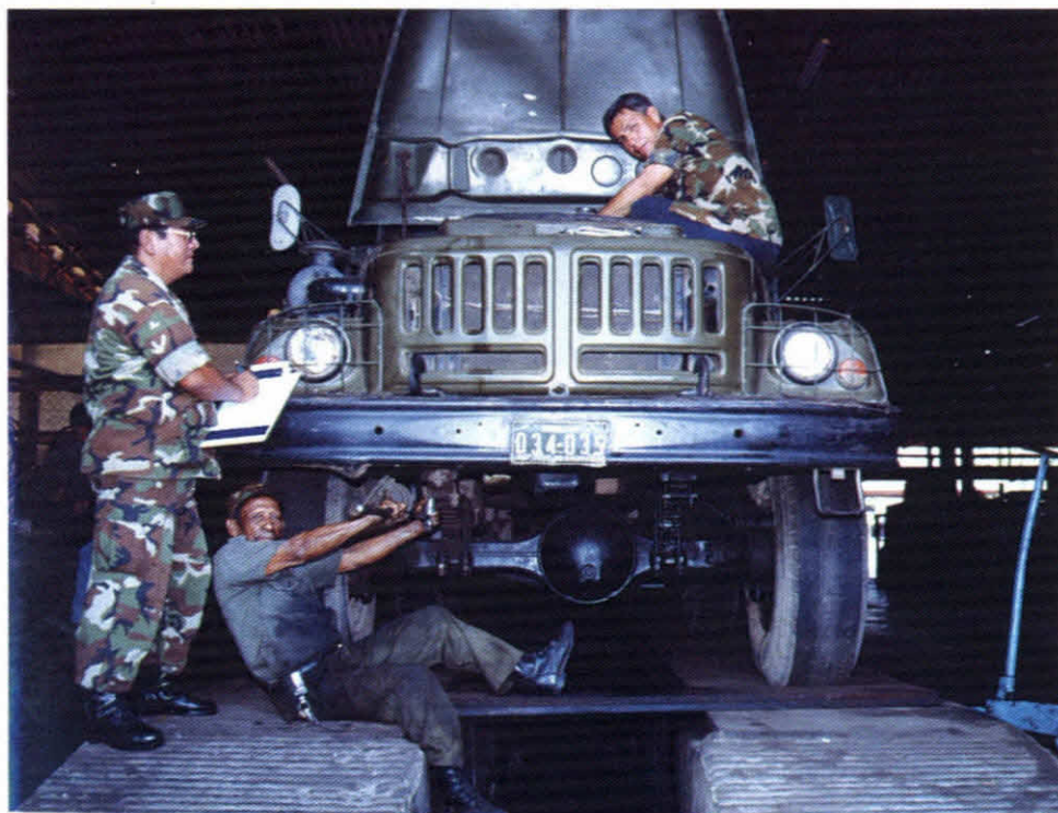
Remotorización de camiones de fabricación Rusa con motores Mercedes Benz
